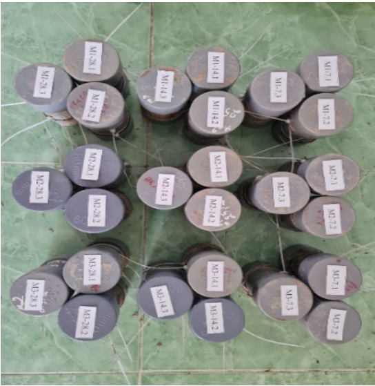
Hình 1. Mẫu xi măng đất đã được đánh số thứ tự
