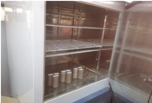
Hình 3: Bảo dưỡng mẫu trong điều kiện bảo dưỡng 3
